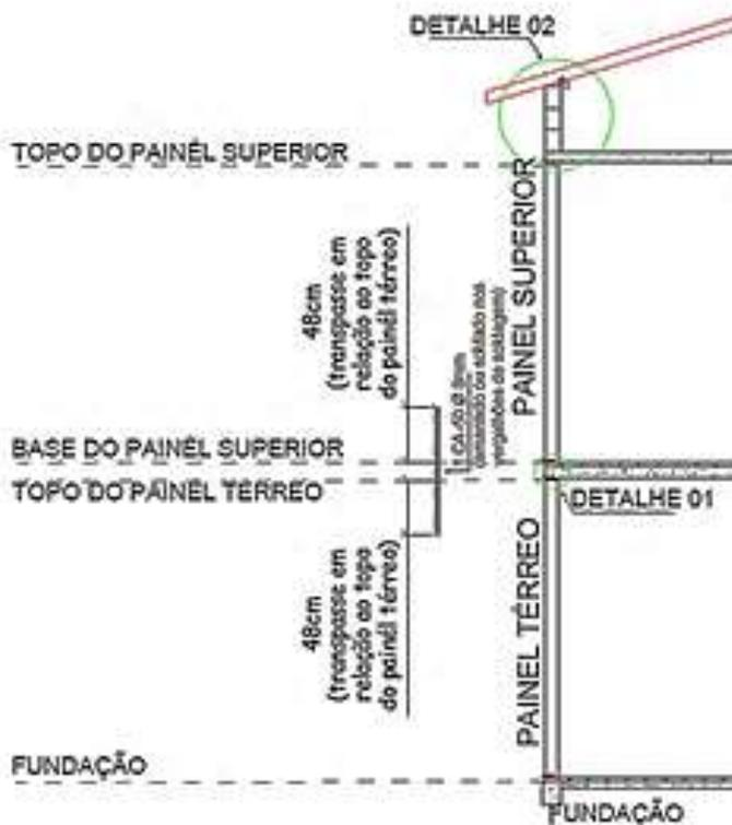
Figura 23 – Ligações entre dois painéis e barra de transpasse entre painel do pav. térreo e painel do pav. superior.
